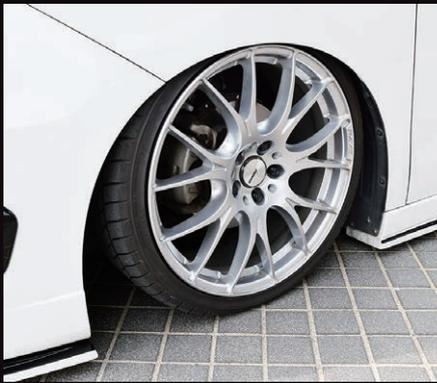
車高を最大限に落とした状態のフロント部。ホイールとフェンダーがツライチになるようにセッティングされているのがよく分かります。
