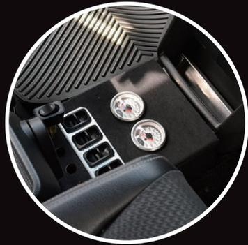
センターコンソール部にはオーナーが自作したエアサスのコントローラー BOXを装着。エアサスは前後4カ所のサスペンションにエアを送るために「エアホース」を配管する必要がありますが、その取り回しを含めた取付けには信頼できるSHOPのノウハウが必須です。エアサス取付けにご興味のある方はぜひTTSさんに相談してみてくださいね。
